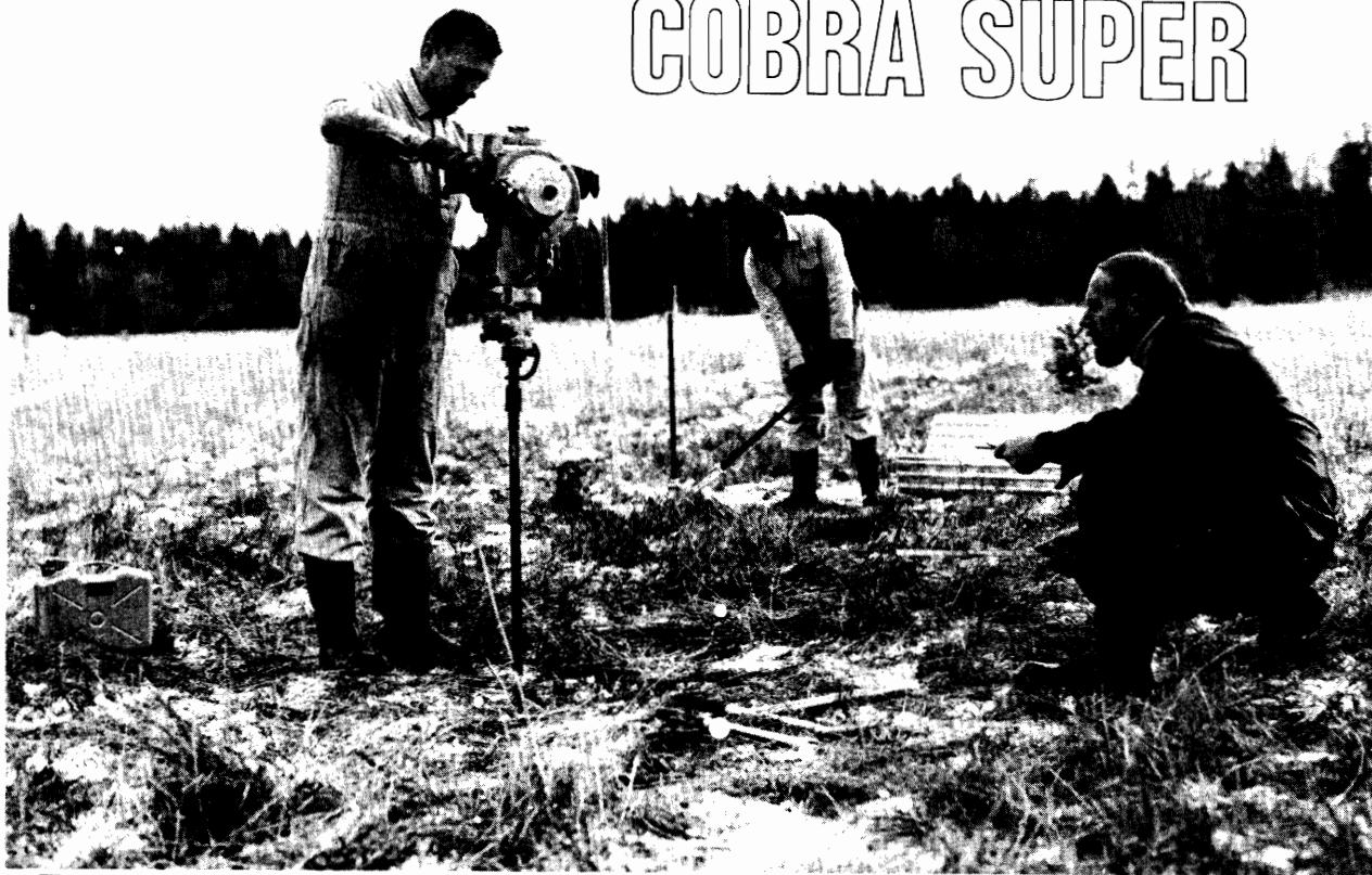
2A) COBRA bor við könnun á þykkt lausra yfirborðsлага. Í baksýn er maður að tjakka borstangir upp úr næstu holu á undan.
