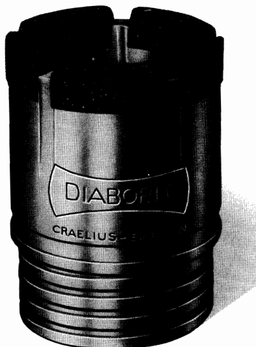
7C) Demantskróna fyrir hart berg. Margir litlir demantar eru steyptir í krónubannann (impregnated bit). Sjá helstu stærðir í töflu 2.
