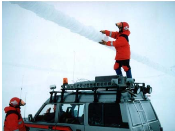
Fig. 12: Incloud icing on a conductor.
