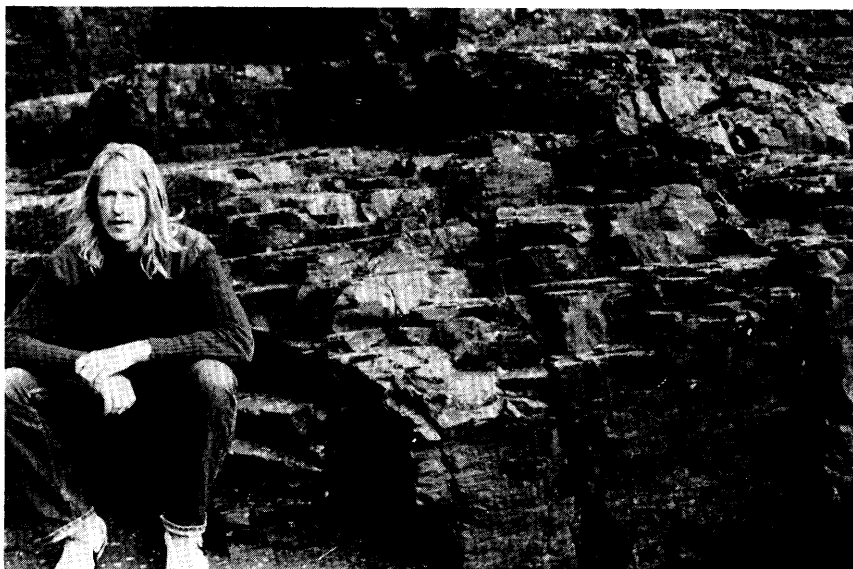
Ljósmynd 11. Grímsárvirkjun. Myndin er tekin úti í farvegi Grímsár og sýnir hversu straumflögótt og brotið bergið er.
