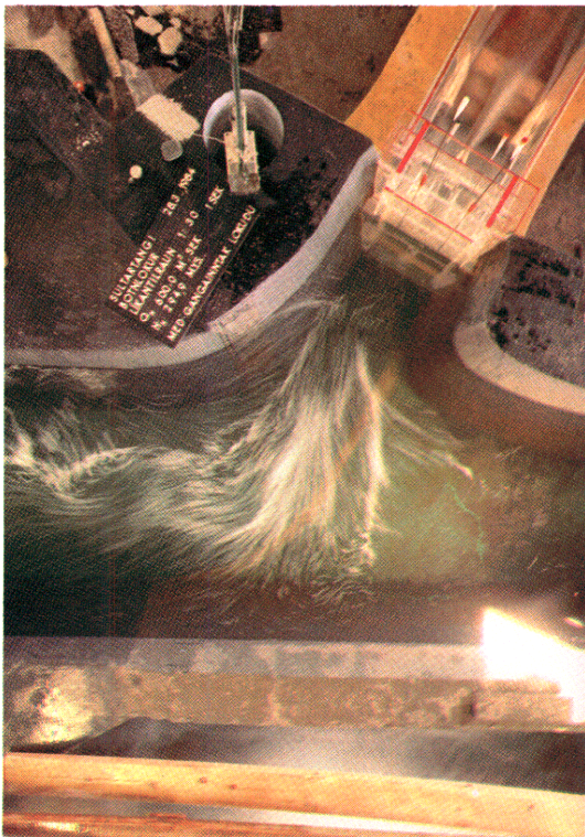
Ljósmynd 11 Straumlag í inntaksskurði, gangainntak opið, botnrás opin og rennsli 600 m 3 /s
