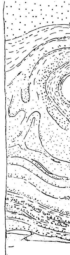
Mynd 14. Fellingar í sandsteini og siltsteini á 409 m dýpi. Setið hefur skriðið til eftir botni án þess að tapa samloðun sinni.
