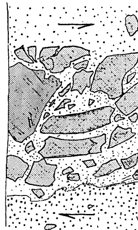
Mynd 12. Siltsteinsklumbar í fíngerðum sandsteini á 358,5 m dýpi. Siltið hefur upphaflega myndað samfellt lag, en það hefur brotnað upp eftir að hafa stífnað. Brotin benda til lárréttar skúfspannu á siltlagið, t.d. vegna sterks straums, hruns eða skriðufalla yfir lagið.
