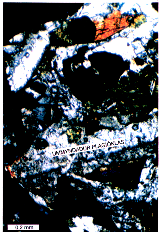
Mynd 29. Ummyndaður dólérít brotkorn. Mg-16, dýpi 1620 m. Plagióklas ummyndaður og jaðrar á pýroxeni.
