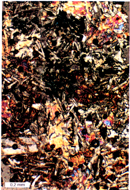
Mynd 23. Ummyndað ólívínþóleít úr hólú Mg-6 af 320 m dýpi.
