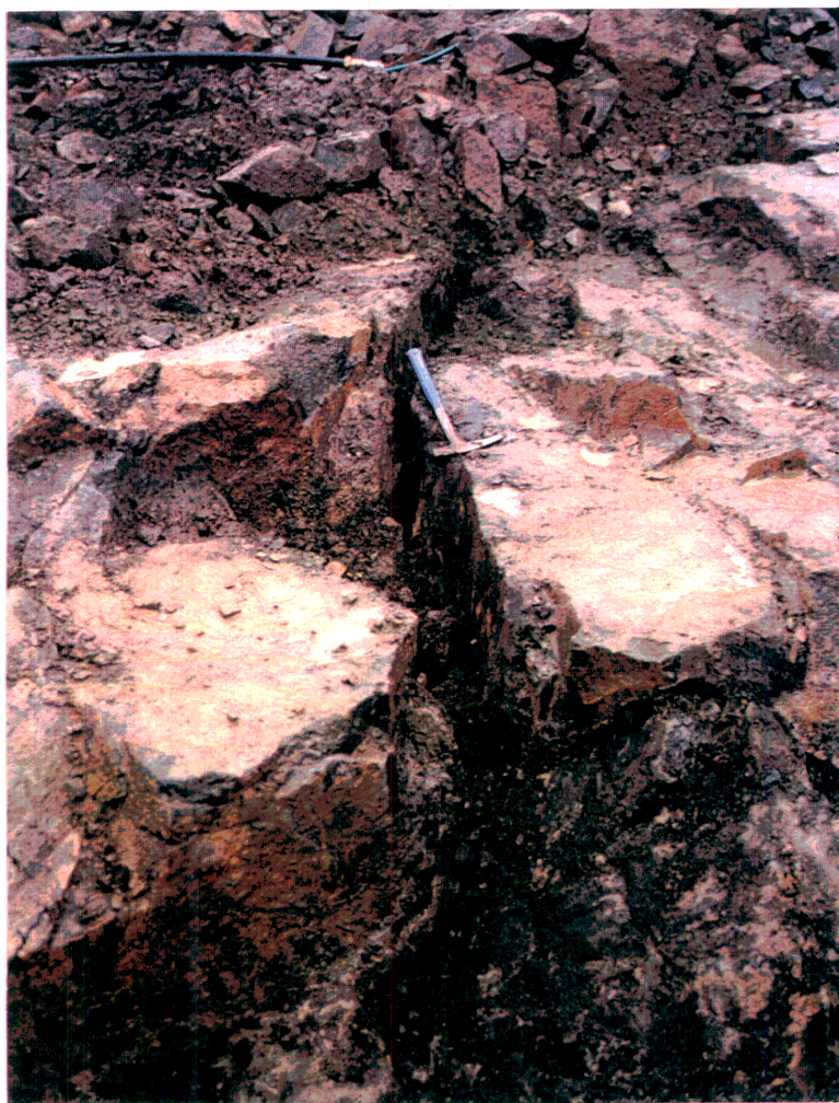
Mynd 6. Ljósmynd af sprungum í vegstæði, horft til suðurs. Stæði fyrir miðstólpa er uppgrafið, vinstra megin við skóflu.
