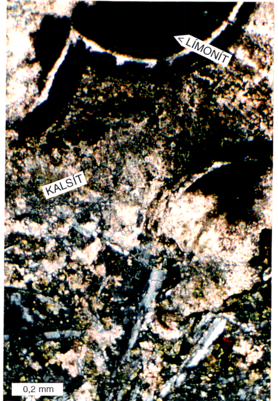
Mynd 11. Blaðra fyllt með kalsíti og límoníti. Það sést einnig að kalsítið frá blöðrunni hefur ummyndað pýroxengrunninn í kringum blöðruna. MG-39 dýpi 520 m. Þunnsneið nr. 7410.
