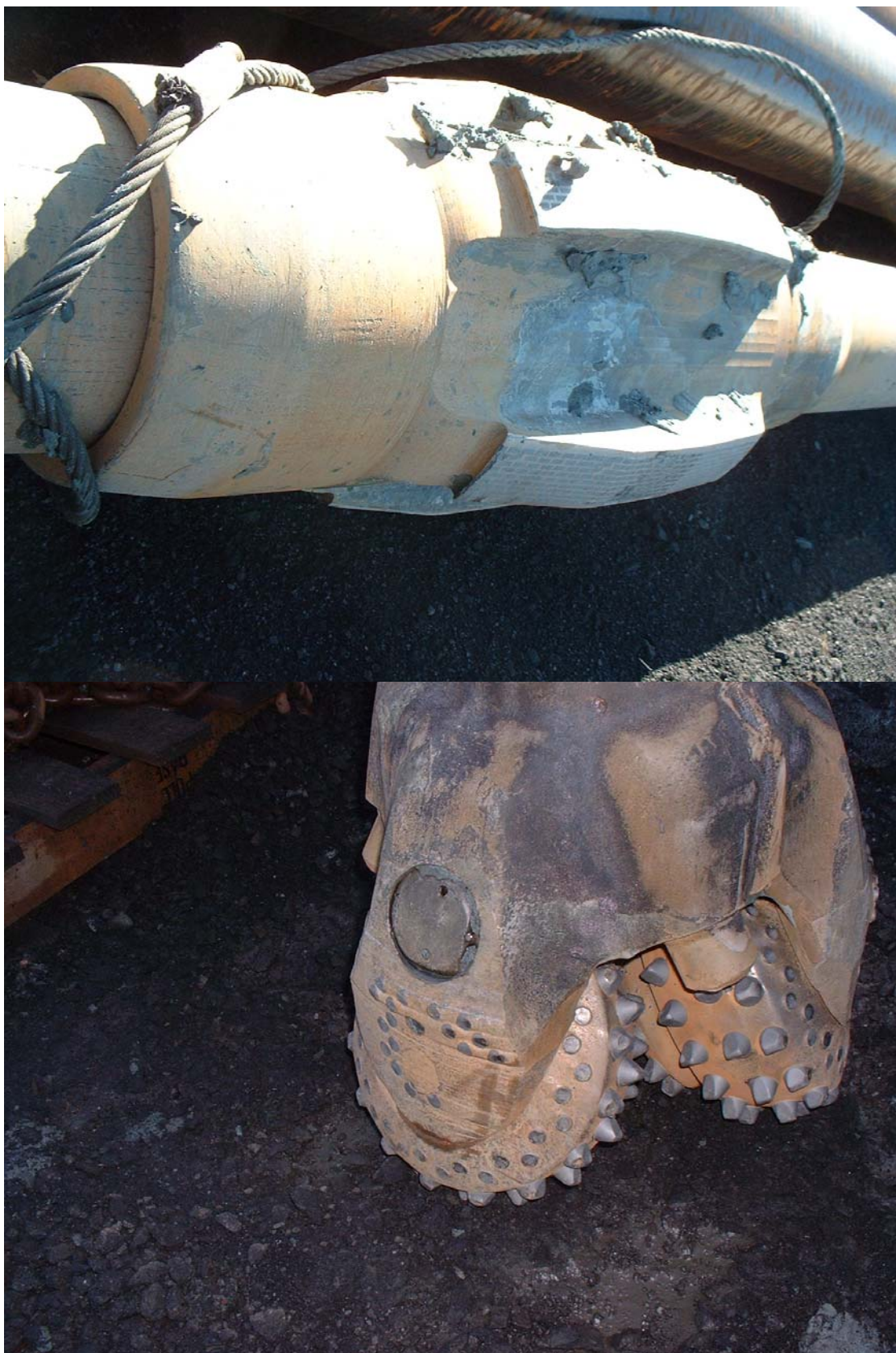
Viðauki 3: Myndir af ónýtri borkrónu og stýringu.
