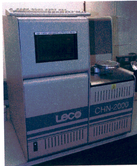
Mynd 3. LECO tækið sem notað var til að staðfesta TOC-greininguna úr Rock-Eval 6.
