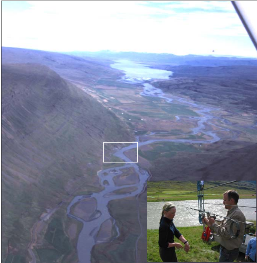
Mynd 2: Yfirlitsmynd yfir farveg Jökulsár í Fljótsdal. Kláfurinn við Melgrófarlæk liggur rétt neðan við beygjuna á ánni í ferhyrningnum. Innfella myndin sýnir undirbúning straumsjármælingar á kláfnum. Ljósmyndir: Oddur Sigurðsson og Júlíus Brynjarsson.
