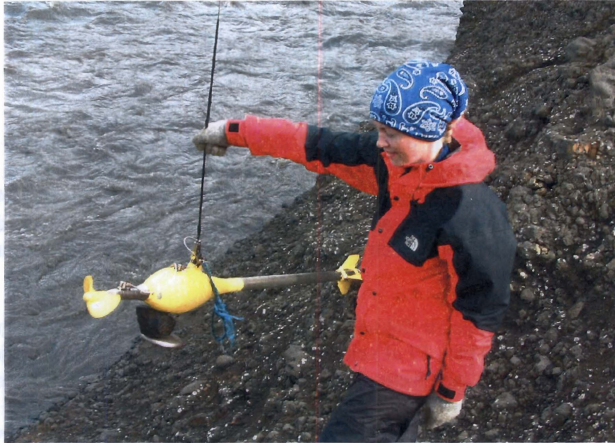
Mynd 76: Steinn fastur í straumhraðamæli við vestari kvísl. Þvermál fótar mælisins er um 15 cm.
