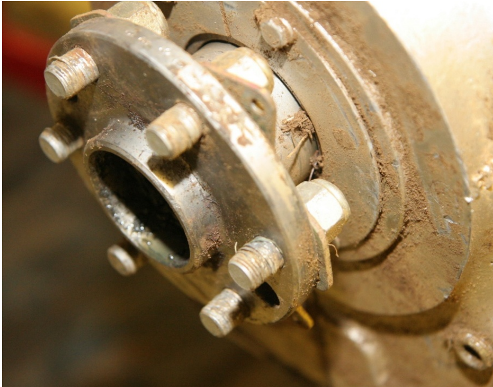
Mynd 5: Boltar í nafi á sveifarás. Boltar hafa togast út.
