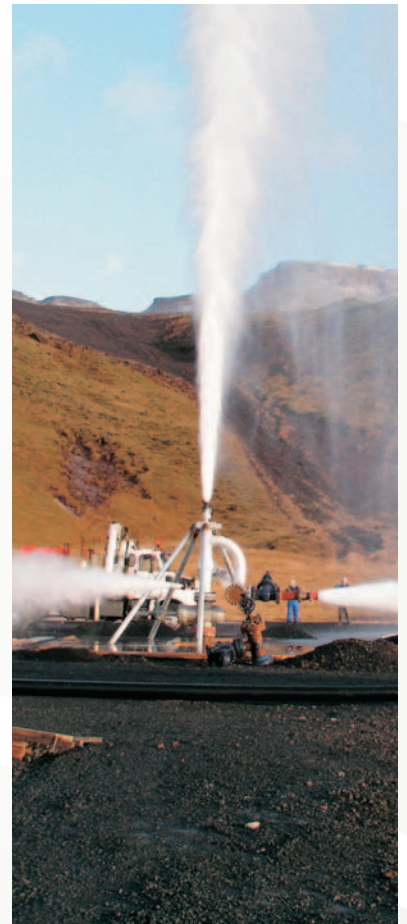
Í lok borunar holu HÉ-13 var reynt að örva hana með því að senda lofttappa niður holuna og láta hana síðan losa lofttappann, þ.e. ropa. Slík aðgerð myndi snúa við rennsli í æðum holunnar og hugsanlega losa svarf úr þeim. Á myndinni sést þegar hola HÉ-13 losar sig við loftið.
