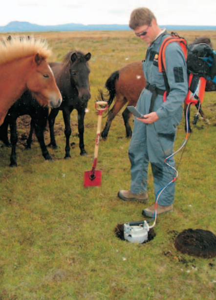
Mælingar á koltvísýringsflæði um jarðveg í Öxarfirði í ágúst 2004. Mælihölf er lagt á jörðina og styrkur koltvísýrings í hölfinu er mældur með ljósgleypnimæli sem komið er fyrir í bakpoka. Aukning á styrk koltvísýrings í hölfinu er mælikvarði á flæði um jarðveginn.
