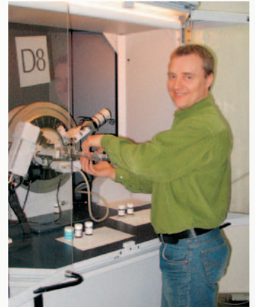
Nýr röntgengreinir var tekinn í notkun á árinu. Með honum eru einkum greind sýni af svarfi við bergfræðirannsóknir og af útfellingum í jarðhitakerfum, auk sýna frá byggingar- og lyffjaidnaði.
