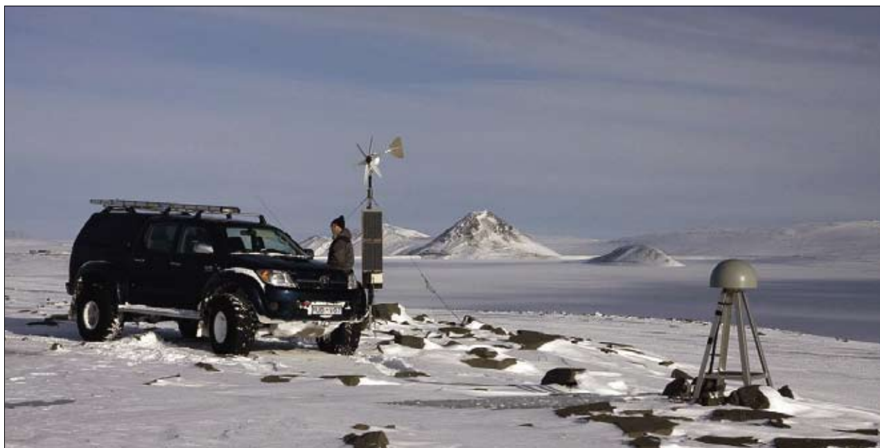
Samfelldar GPS-mælingar á Saudárhálsi við Kárahnjúka hófust hinn 30. október 2004. Á myndinni, sem tekin er snemma árs 2008, sést GPS-stöðin til vinstri en vindrafstöð og sólarcellur eru við bílinn. Kárahnjúkar fjær. Tækjabúnaður á Saudárhálsi er kostaður af Landsvirkjun. (Ljós.: Jósef Hólmjárn.)
