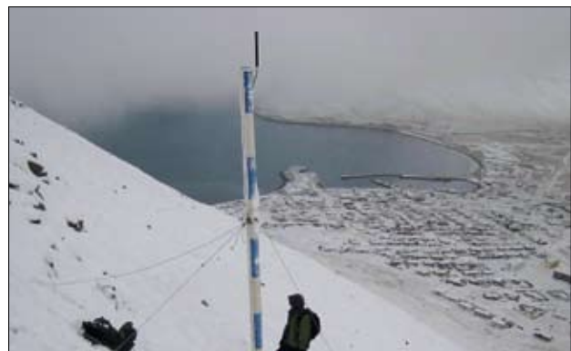
Snjókýptarmælir var settur upp í um 500 m hæð í Traðargili fyrir ofan Bolungarvík í október 2006. (Ljós.: Örn Ingólfsson.)
