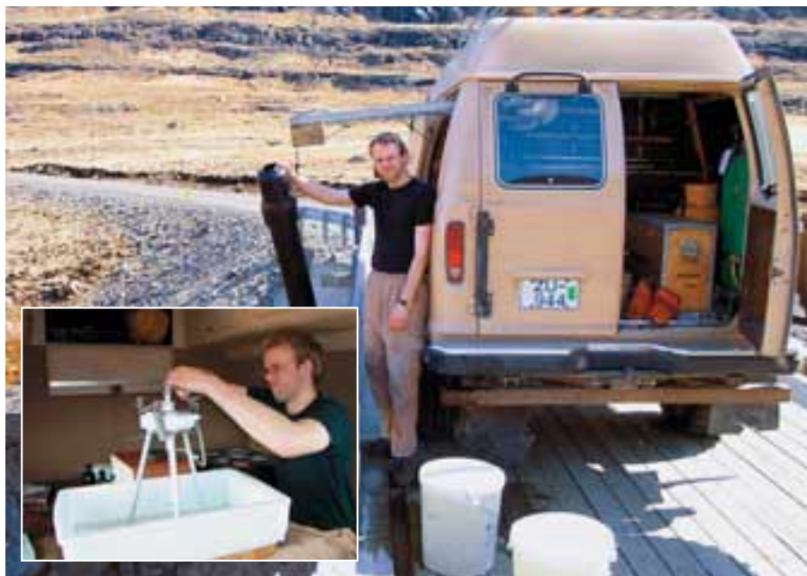
Hér er verið að taka sýni til efnagreininga úr Jökulsá á Dal og vinna að síun sýnisins og frágangi fyrir greiningu. Jafnframt eru tekin sýni af aurburði. Samstarf er milli Vatnamælinga og Raunvísindastofnunar Háskólans um efnavöktun á Suður- og Austurlandi á vegum Landsvirkjunar, AMSUM-verkefnið umhverfisráðuneytisins og Auðlindadeildar Orkustofnunar. Niðurstöður rannsókna hafa mikið vísindalegt og hagnýtt gildi á mörgum sviðum og hafa þær m.a. nýst vegna undirbúnings Kárahnjúkavirkjunar. Ljós. Sigvaldi Arnason.
