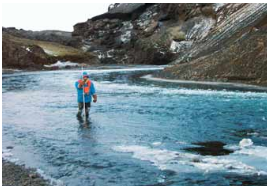
Rennslismæling í Lónakvísl (vhm 405). Lónakvísl rennur í Tungnaá úr austri við Faxasund. Ljósm. Sigvaldi Árnason.
