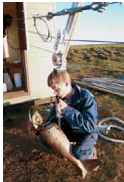
Rafdrifin strengjabraut var sett upp árið 2001 við Þjórsá hjá bænum Króki fyrir Landsvirkjun til mælinga á aurburðir vegna fyrirhugaðra virkjana í Neðri-Þjórsá. Hér er verið að skipta um sýnatökuflösku í punktsýnataka fyrir svifaur. Til hægri sést sýnataka fyrir botnskriði. Ljós. Svala Björk Þorláksdóttir.
