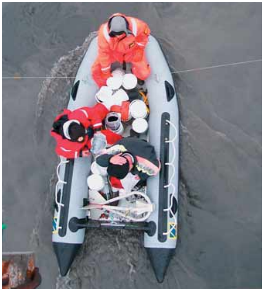
Söfnun botnskriðssýna í Skaftá við Sveinstind sumarið 2001. Myndin er tekin úr mannbærum kláfi yfir ána, og var sýnatakin (aftast í bátinum) hífður upp og niður frá honum. Skipt var um sýnatökupoka, sýnum safnað og þau merkt í bátinum. Verkið var tilraunaverkefni unnið af Vatnamælingum fyrir Landsvirkjun vegna mögulegrar veitu Skaftár yfir til Tungnaár. Ljós. Kristinn Einarsson.
