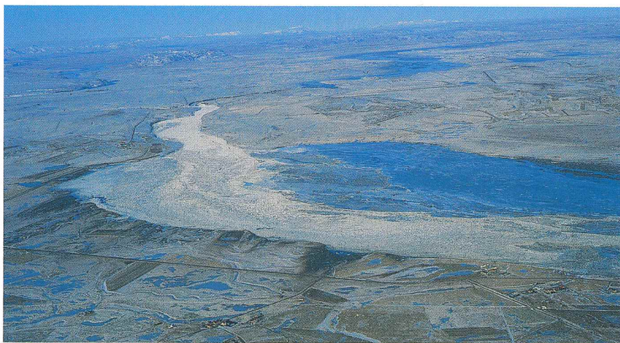
Íshrónn við Urriðafoss í Þjórsá í byrjun mars 1998, en þar er neðsti virkjunarstaður í ánni. Hrönnin myndast nær árlega og hefur hún náð um 18 m hæð.
