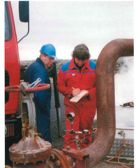
Mæling á afköstum holu 11 í Svartsengi. Notuð var sérsníðuð skilja og ástand ofanjarðar og neðan skráð með stafrænum skynjurum. Verkið er liður í undirbúningi vegna stækkunar orkuversins. Ljós. Sigvaldi Thordarson.
