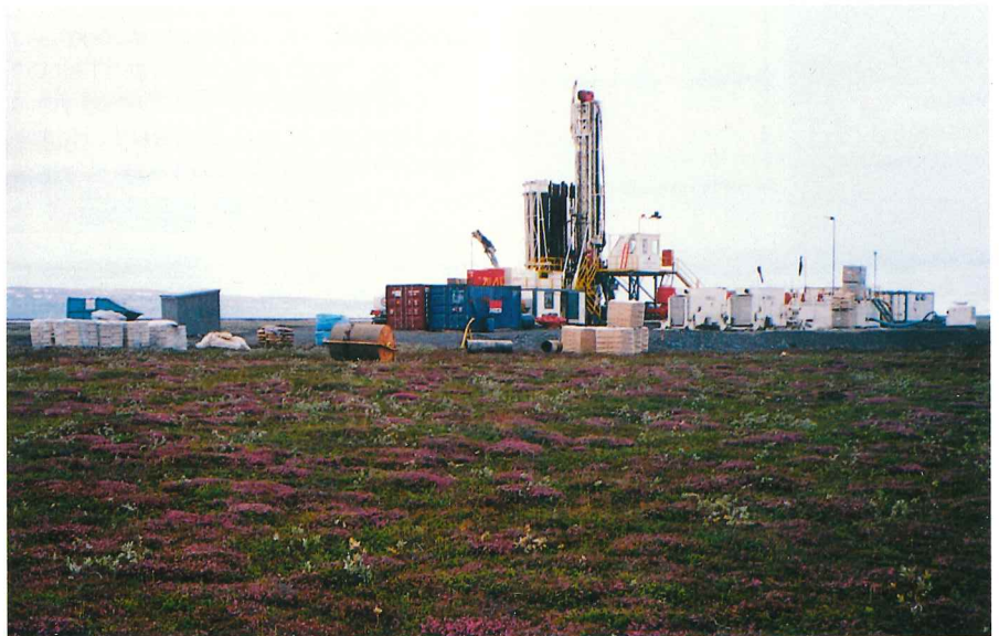
Frá borun fyrstu djúpu rannsóknarholunnar (BA-02) á meintu háhitasvæði í Öxarfirði á vegum Íslenskra orku ehf. Notaður var nýr jarðbor Jarðborana hf. (Sleipnir). Holan varð 1962 m djúp. Ljós. Guðmundur Ómar Friðleifsson.
