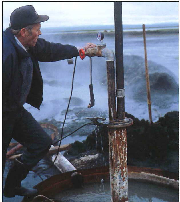
Árið 1987 fannst vottur af lífrænu gasi við borun eftir heitu vatni við Skógarlón í Óxarfirði. Á myndinni er Björn Benediktsson frá Sandfellshaga við holu 1. Ákveðið hefur verið að bora allt að 2000 m djúpa holu á árinu 1999 til að kanna háhitavæðið í Óxarfirði. Jafnframt verða settlöggin skoðuð og hvort trekari vísbendingar finnast um olíu. Ljós. Guðmundur Ómar Friðleifsson.
