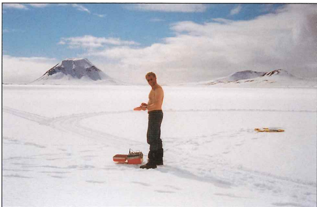
Stærð jarðhitasvæðisins í Köldukvíslarbotnum var könnuð með TEM-viðnámsmælingum. Myndin sýnir starfsmann við mælingar í mars 1998 þar sem nú er lón Hágöngumiðlunar. Syðri-Háganga í baksýn. Ljós. Einar Hrafnkell Haraldsson.
