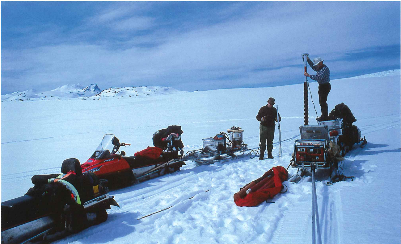
Afkomumælingar á Hofsjökli í maí 1997. Bræðslubor og snúningsbor. Kerlingarfjöll í baksýn. Ljós. Oddur Sigurðsson.
