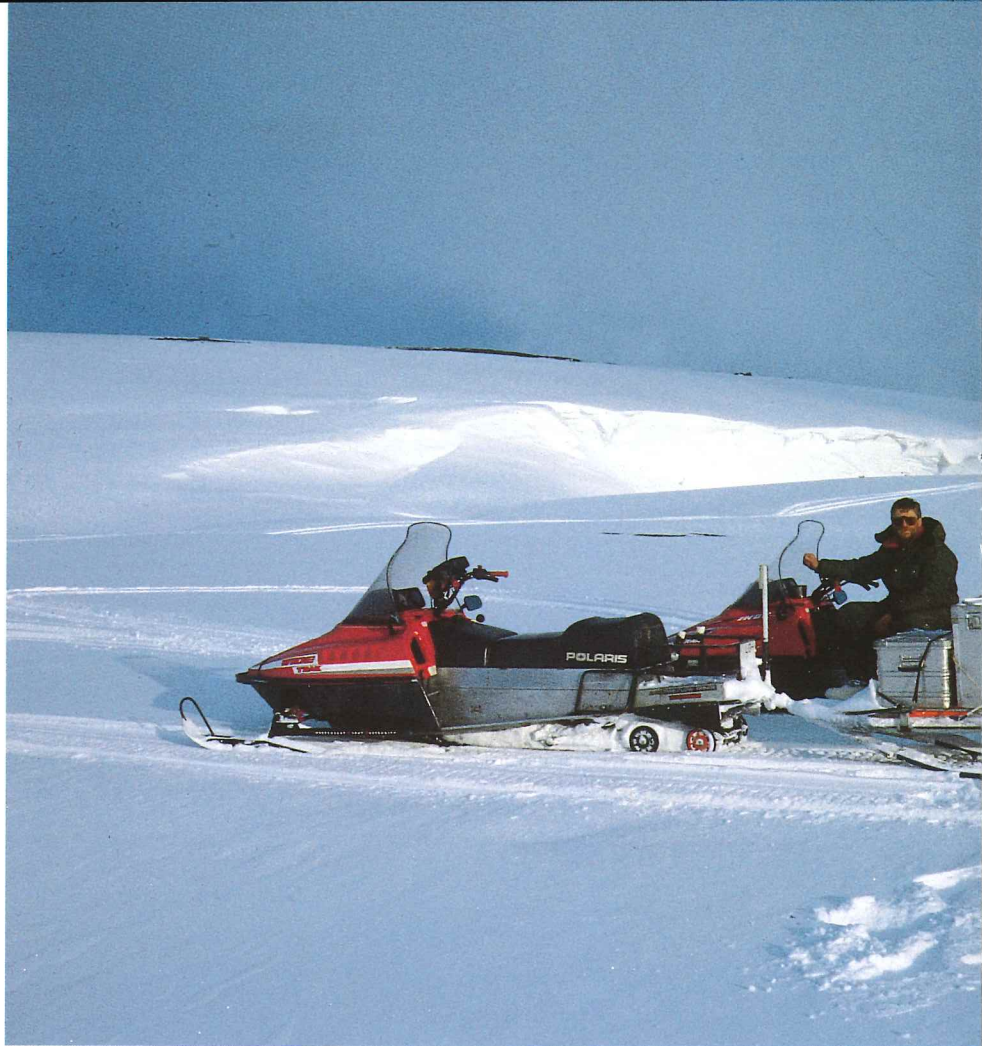
Unnið við TEM viðnámsmælingar á snævipakinni jörð á Torfajökullssvæðinu í maí 1993. Við slíkar aðstaðna námsmæla á svæðum sem eru óaðgengileg þegar jörð er auð. Ljós. Knútur Árnason.
