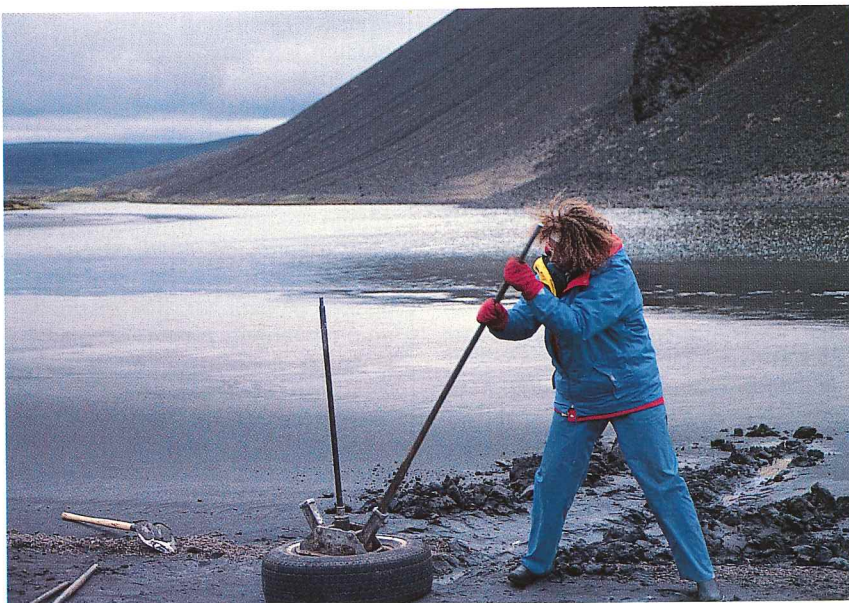
Sumarið 1992 var könnuð undirstaða stíflu í skarði í Þorlákslindahrygg við Arnardal á Möðrudalsöræfum. Dípy á fasta klöpp reyndist vera ríflega 25 m. Myndin sýnir borstangir dregnar upp að lokinni borun. Ljós. Þórólfur H. Hafstað.
