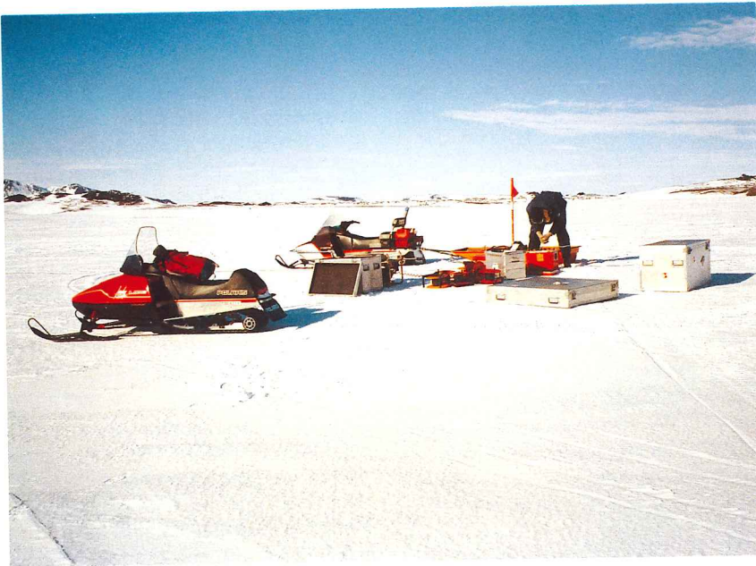
Unnið við TEM-mælingar á snævipakinni jörð í Kröflu í apríl 1991. Einar Hrafnkell Haraldsson. TEM resistivity survey on snow in the Krafla Geothermal Area in April 1991.
