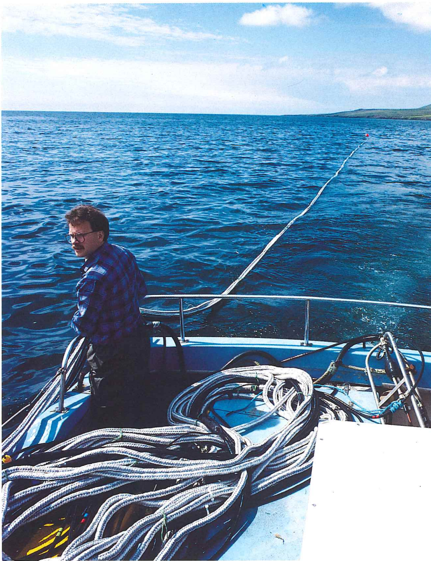
Bylgjubrotsmælingar í Hvalfirði við könnun á áætluðum jarðgangaleiðum. Ólafur G. Flóvenz. Geophysical survey on proposed tunnel routes below Hvalfjörður bay, Western Iceland.
