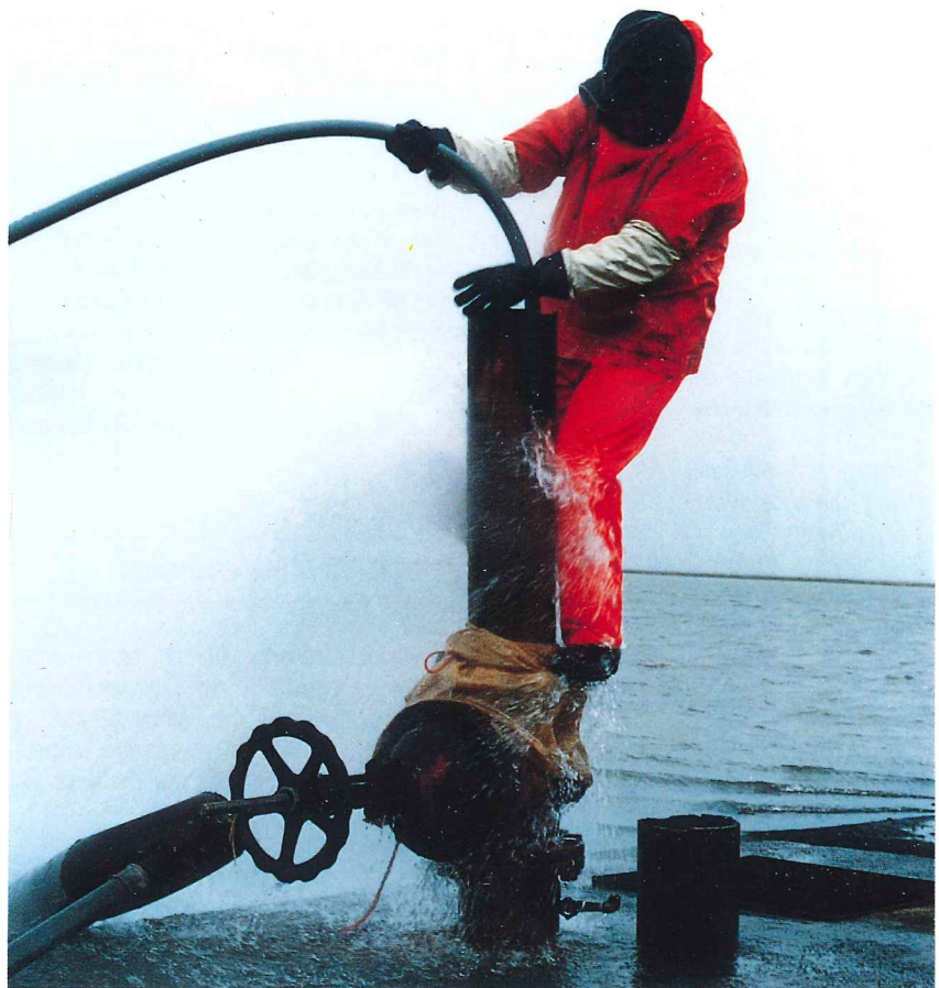
Árið 1988 fannst, í fyrsta sinn á Íslandi, vottur jarðgass í tveim borholum við Skógalón í Öxarfirði. Sýnataka af 200 m dýpi. (Ljósmynd/Photo Magnús Ólafsson).
