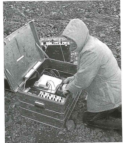
MT-mælingar á Dynjandisheiði voru gerðar til að rannsaka djúpvíðnám jarðskorpunnar frá 5 km niður á 50 km dýpi. (Ljóm./photo Hjálmar Eysteinnsson).
