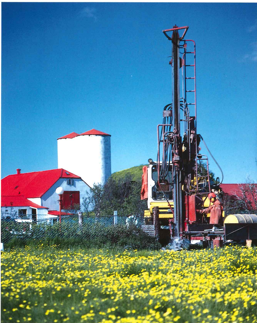
Leitað með hitastigulsborunum að uppstreymi jarðhitans við Laugabakka, fyrir Hitaveitu Selfoss. (Ljósmynd/ photo Helgi Torfason).
