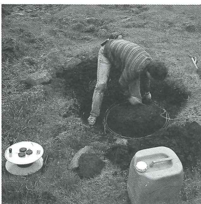
Starfsmaður JHD gengur frá rafskauti fyrir tvíþólamælingar (ljósm./photo, Ólafur G. Flóvenz) Digging down a current electrode in resistivity measurements (dipole-array).
