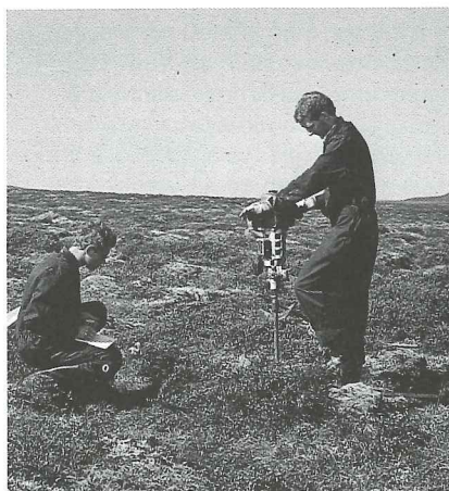
Léttur titringsbor (cobra-bor) er oft notaður til að kanna þykkt lausra jarðefna (dýpi á fast). Myndin sýnir hvar verið er að bora með cobra-bor á skurðleið við Austara Friðmundarvatn vegna Blönduvirkjunar. (Ljós-./photo, Ágúst Guðmundsson).
