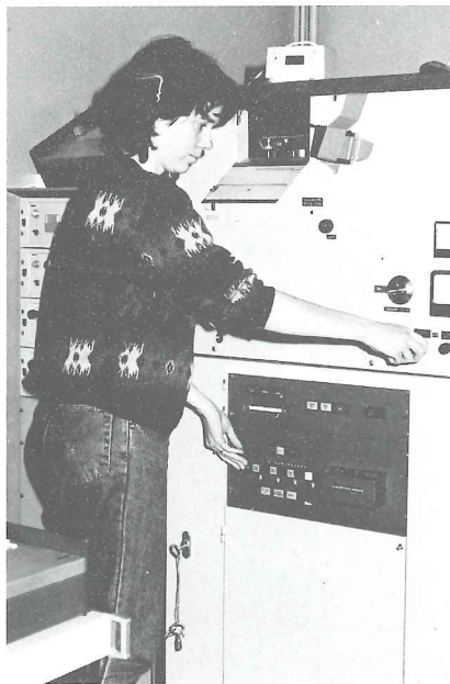
Unnið við röntgen efnagreiningartæki á Jarðeðlisfræðideild. Tækið er einkum notað til að efnagreina útfellingar og tæringarefni. Ljósmynd: Snorri Zóphóniasson.
