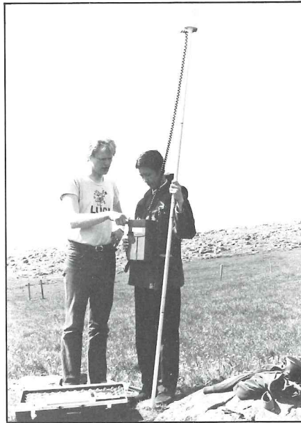
Sérfræðingur af Orkustofnun leiðbeinir nemanda úr Jarðhítaskóla Sameinuðu þjóðanna við segulmælingar. Þessar mælingar eru mikið notaðar við jarðhitarannsóknir m.a. til þess að kortleggja ganga.
