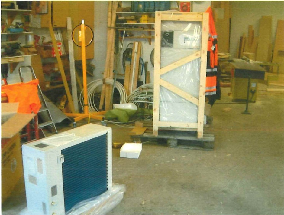
Mynd 3. Varmadæla, nær á myndinni og rafhitunarbúnaður með vatnstanki enn í umbúðum á myndinni fjær.
