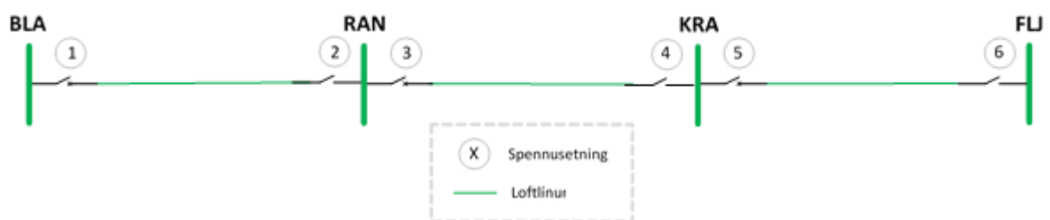
Mynd 6-8 - Spennusetning á 220 kV línunum. Innsetning frá BLA að FLJ
