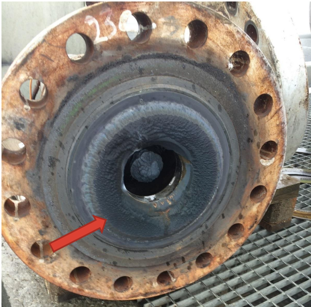
Mynd 5.2 Útfellingar í lögn aftan við holutoppisloka. Örin bendir á útfellingarnar.
