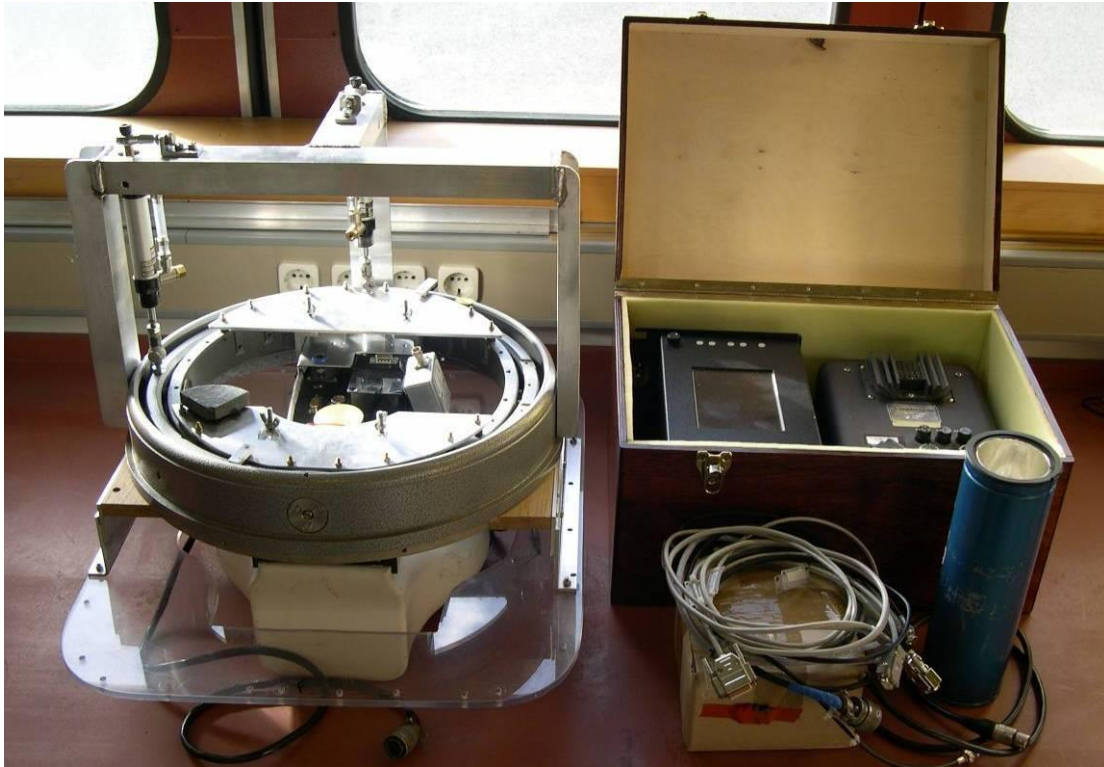
Mynd 5. Hitaskanninn með núverandi festingum (vinstra megin) og öllum öðrum búnaði (til hægri). Heildarþyngd alls tækjabúnaðarins er um 50kg.
