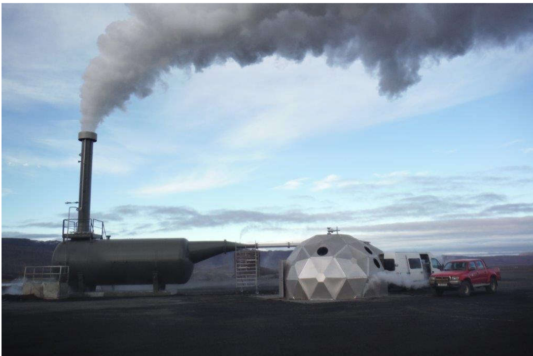
Mynd 8: Borhola ÞG-11. Dæmi um hljóðdeyfi á borholu.
