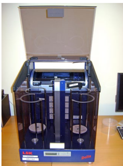
■ En af de robotter, der anvendes til læsning af DVD'er i forbindelse med medietest.
