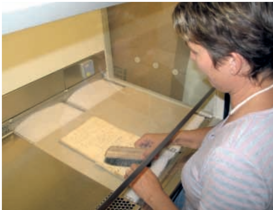
■ Støv og snavs bliver forud for konserveringsfilmmningen fjernet fra arkivalierne ved en afbørstning. Arbejdet foregår ved en miljøbænk, så medarbejderen undgår indånding af støvpartikler og evt. svampesporer. Foto: IT-medarbejder Erling Haagh.
