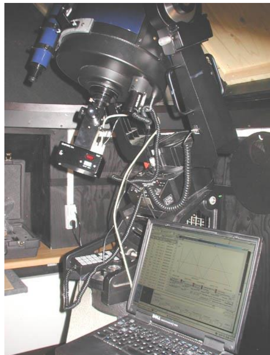
Myndir 1a-b. a) SBIG STL11kM myndflöguvél á Meade LX 200 30 cm (12") sjónauka. b) Optec SSP-3 ljósmælir á sama sjónauka.
