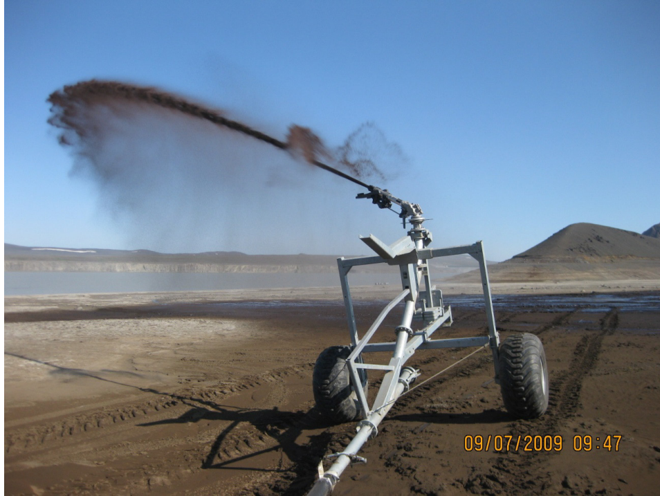
Mynd 21 Dreifisprauta Rainstar dreifarans. Slöngukeflið dregur dreifisprautuna til sín.
