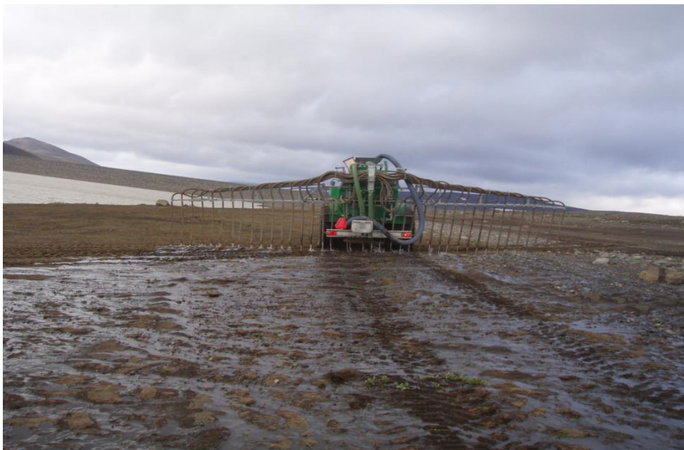
Mynd 22 Rykbindiefni dreift með traktor sem búinn er sérstökum dreifara.
