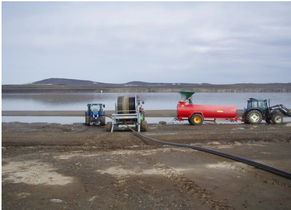
Mynd 20 Slöngukefli Rainstar dreifarans fyrir miðri mynd. Vinstra megin er traktor með haugsugu.
