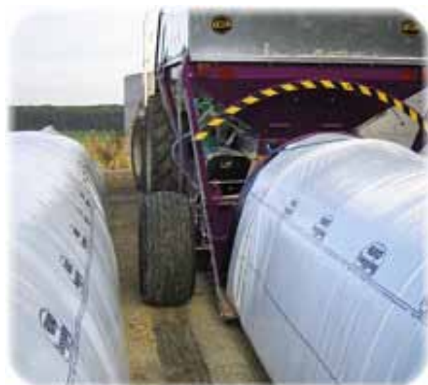
Mynd 4.8 Sambyggður valsari, súrsari og pylsu-fyllir fyrir korn. Kornið er valsað, sýru blandað í það og korninu síðan troðið í plastklædda pylsu. Pylsan er 1,5 – 2 m í þvermál og hana má gera tugi metra á lengd. Hliðstæð tækni hvað snerti verkun og geymslu á heyi kom fram á síðari hluta síðustu aldar ( www.kortteenkonepaja.com ).
