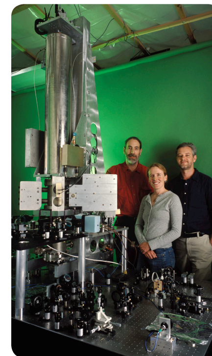
Þessi atómklukka er kölluð NIST-F1 og er í Boulder, Colorado. Hún byggir á geislun frá sesíni og er svo nákvæm að hún hún seinkar sér eða flýtir um minna en eina sekúndu á meira en 100 milljón árum.
