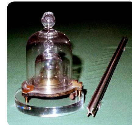
Gamli viðmiðunarmetrinn og viðmiðunarkílógrammið undir þreföldum glerhjúp. Stöngin og sívalningurinn eru úr málminum plátínu.
