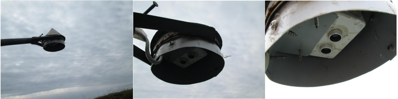
Myndirnar hér að ofan sýna húsið sem var smíðað utan um mælinn sem mælir hæð vatnsyfirborðsins.
