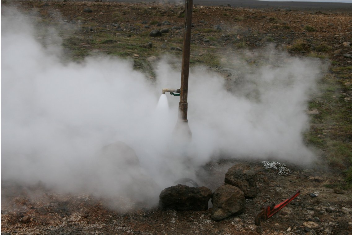
Mynd 2: Hér er útstreymið orðið nokkuð þurrt, enda fellur þrýstingur hratt um stútinn.
