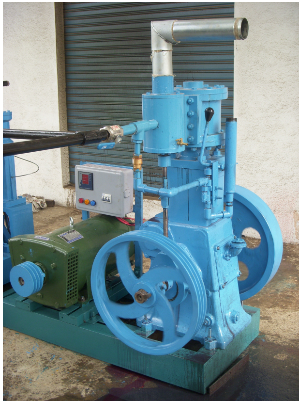
Mynd 7: Eins strokka gufuvél (blá) sem hægt er að tengja við rafal (grænn). Gufan kemur inn um svarta rörið. Kvikmyndir af ýmsum útfærslum þessarar vélar eru á vefnum (sjá tilvísun í texta). Verð er um 7000 USD frá framleiðanda.
