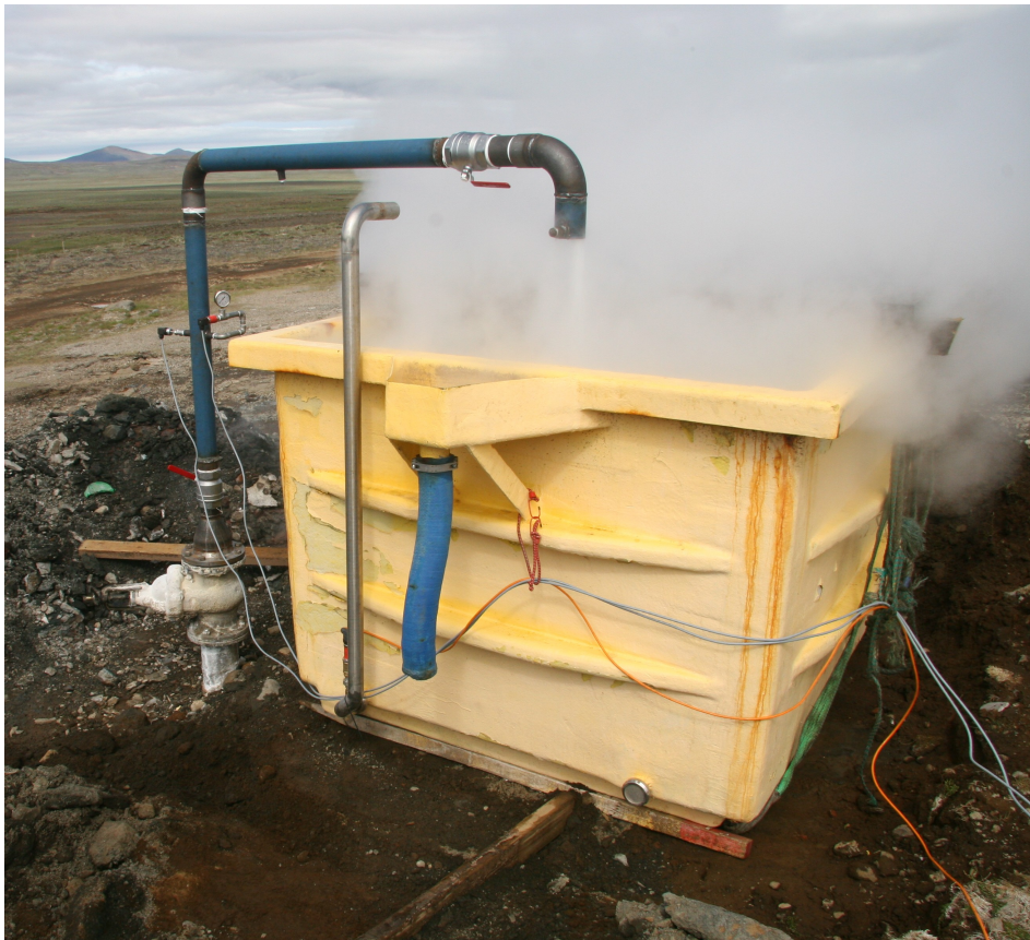
Mynd 3: Uppsetning við holu VE-04 vegna mælinga á rennsli um 3" rör frá 6" holu. Síritandi mælar eru tengdir með köplum.
