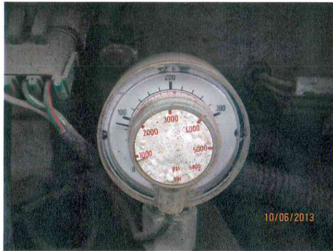
Mynd 9: Þrýstingur á gaskút í bílnum fyrir áfyllingu, ca. 90 bar.
