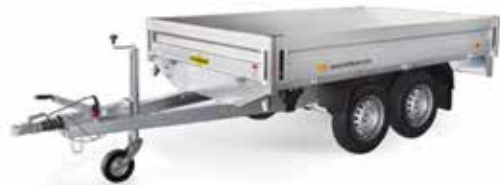
Flatvagnar-ýmsar stærðir, 2000kg-3500kg, mál 2,65x1,65m til 6,10x2,48m.
