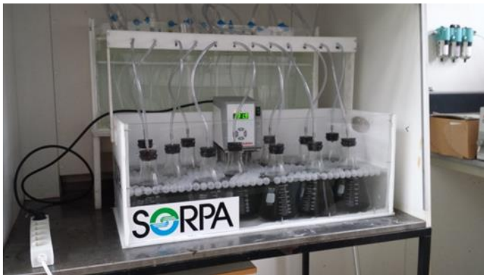
Mynd 6. Tilraunaútbúnaður fyrir metanvinnslu. Tilraun í gangi. Rúmmálmælar eru fyrir aftan gerjunarbúnaðinn.
