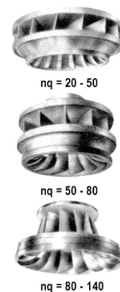
Mynd 6-7 Mismunandi gerðir vatnshjóla fyrir Francis hverfla eftir fallhæð. 13 N_q er eðlishraði hverfils, sjá kafla 6.2
