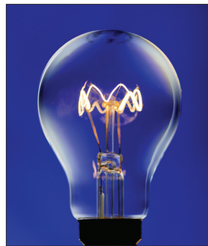
Mynd 3.7 Í ljósaperum eru örgrannir málmþráðir úr volfram. Þegar rafmagn fer um þá hitna þeir svo mikið að þeir verða glóandi.
