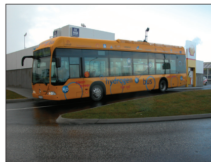
Mynd 4.13 Strætisvagnar knúnir vetni voru fyrst prófaðir í Reykjavík árið 2003. Allur tæknibúnaður vagnanna er hafður á þakinu, en vélin gengur fyrir rafmagni sem myndast við efnahvarf vetnis og súrefnis í sérstöku tæki sem kallast efnarafall.
