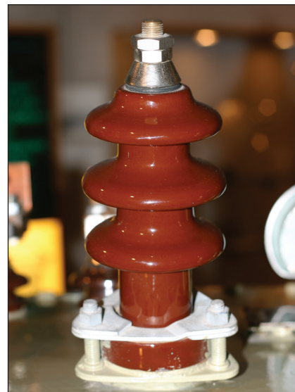
Mynd 3.15 Einangrunarkefli úr bakelit. Bakelit er fyrsta lífræna gerviefnið sem mönnum tókst að framleiða.
