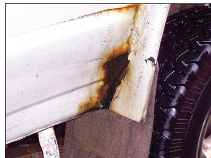
Mynd 2.22 Þessi bíll er farinn að ryðga vegna þess að súrefni og vatn hafa komist í snertingu við járneið í bílnum.
