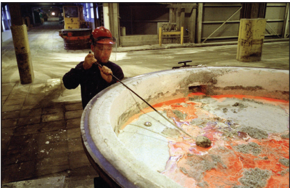
Mynd 1.11 Bráðið ál. Þegar ál er framleitt birtist það fyrst sem vökvi. Þegar það kólnar niður fyrir 660\text{ °C} (sem er bræðslumark þess) storknar það og við fáum ál í föstu formi, af svipuðu tagi og álpappír sem allir þekkja.
