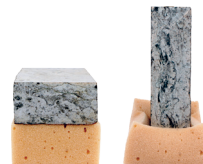
Stór flötur = lítill prýstingur Lítill flötur = mikill prýstingur
