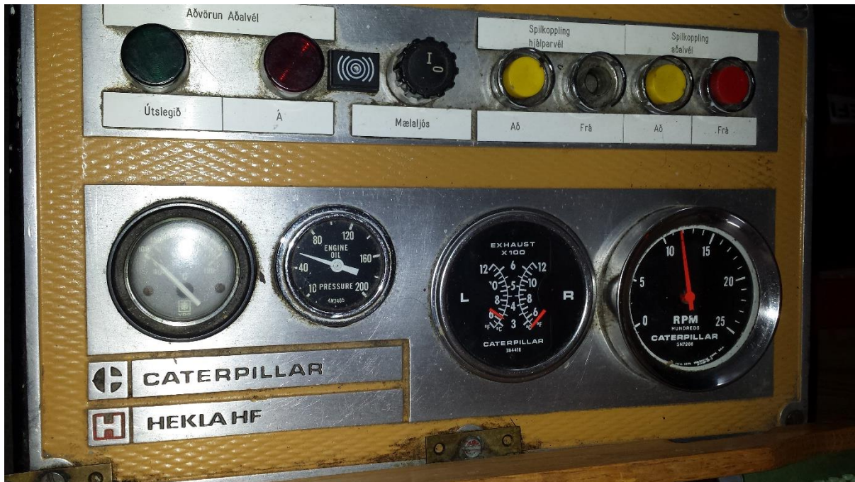
Mynd af mælum aðalvélar Drafnar RE 35. Afgashitastig (e. Exhaust) og snúningshraði vélar (RPM) á eru neðarlega til hægri. Myndi er tekin á siglingu (8 hnúta hraði) og nær afgashitinn rétt yfir 300°C.
