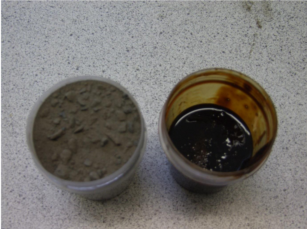
Mynd 2. Sandur eftir útdrátt og þurrkun ásamt olíu eftir asetón útdrátt.
